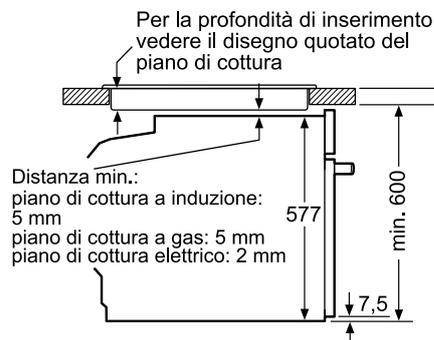
Se l'apparecchio viene montato sotto un piano di cottura deve essere rispettato il seguente spessore del piano di lavoro (event. incl. sottostruttura).
