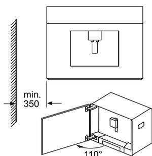
Utilizzando il limitatore di cerniera per una apertura a 92° (ricambio 00636455), la distanza minima al muro può essere di solo 100 mm
