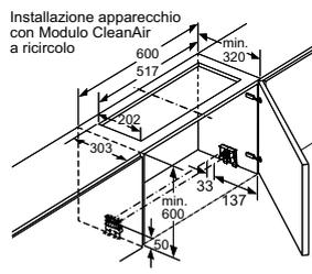
Il modulo a ricircolo CleanAir delle Cappe telescopiche non può essere installato con tipologie di pensile con chiusura basculante. Vedi esempio \*\*
