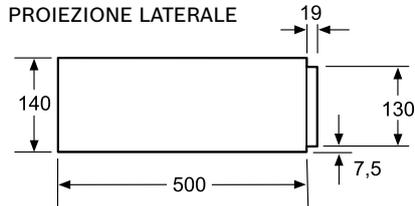
Sopra uno scaldavivande possono essere installati forni compatti con un'altezza apparecchio di 455 mm.
