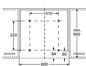
Montaggio del prodotto con accessorio. Cornice di abbassamento "push&hide" direttamente installata sulla parete della cucina.
