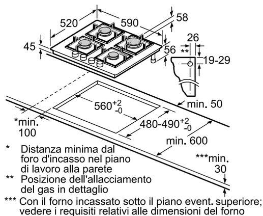
Larghezza 60 cm - Montaggio a filo solo per PPH6A6B20, PPP6A2B20O
