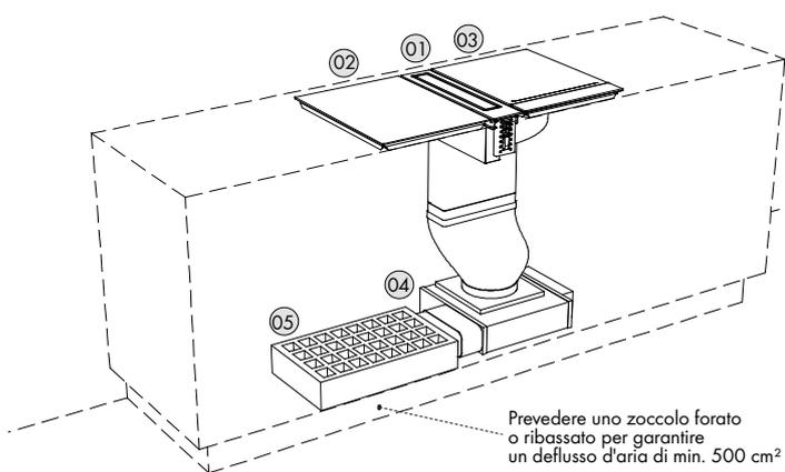
Piano cottura ed elementi canalizzazione
