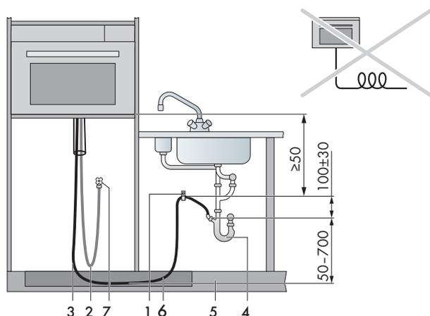
**Attenzione:** il collare di serraggio del tubo flessibile (1) deve essere montato ad un'altezza di 700 mm (vedi fig. a sinistra).
