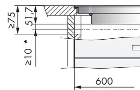
Requisiti per una ventilazione ottimale
