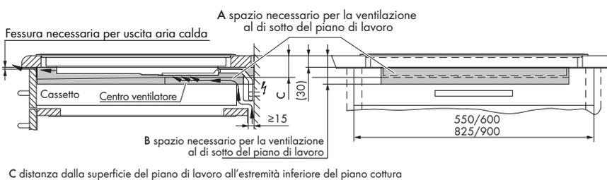
C distanza dalla superficie del piano di lavoro all'estremità inferiore del piano cottura
