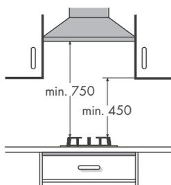
Quando montate una cappa di aspirazione sopra il piano cottura a gas rispettate la distanza minima di 750 mm.
