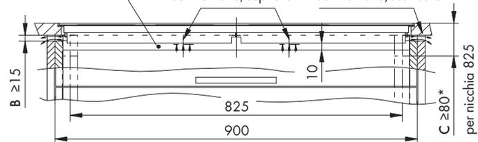
B Spazio necessario nelle pareti laterali a destra e a sinistra per la ventilazione dell'apparecchio
