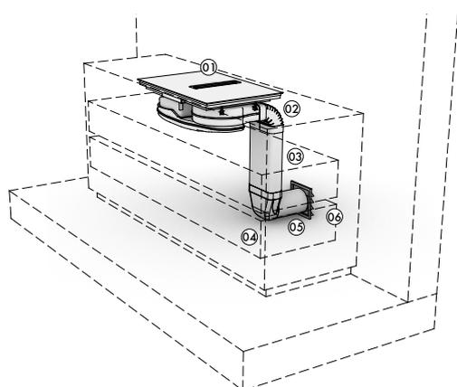
Piano cottura ed elementi canalizzazione
