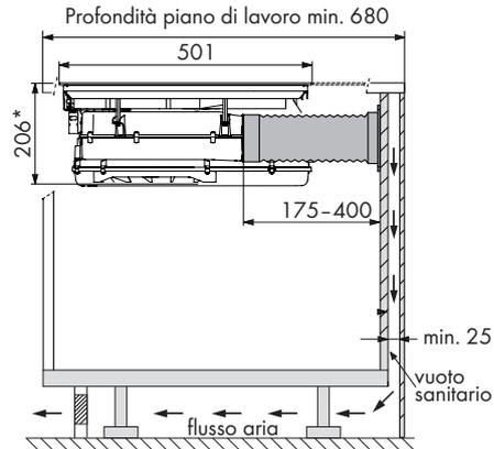
Dimensioni di ingombro con profondità base min. 600 mm
