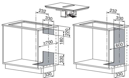
Base profondità  $\geq 700$  mm (collettore flusso aria a destra)
