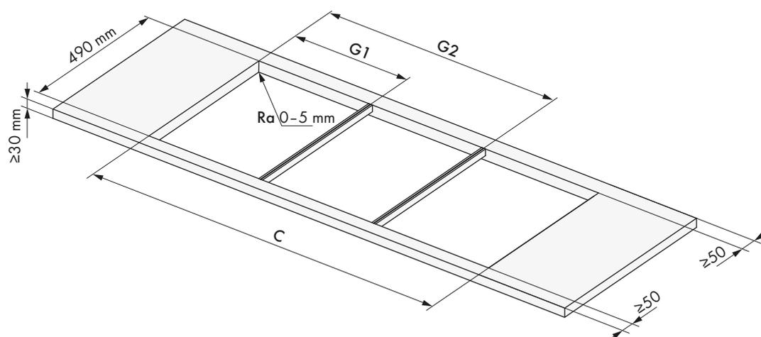
**Attenzione:** non è possibile installare il piano cottura Wok in battuta
