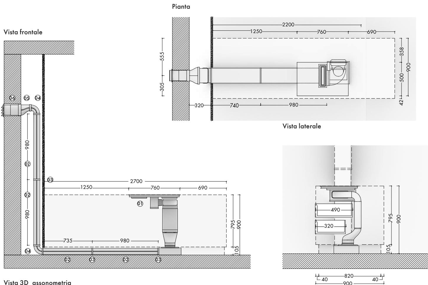
Con zoccolo altezza 105 mm, fare un intaglio nella base di 260x260 mm per l'alloggiamento del motore
