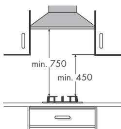
Quando montate una cappa di aspirazione sopra il piano cottura a gas rispettate la distanza minima di 750 mm.
