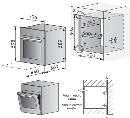
**Attenzione:** per garantire una buona ventilazione la nicchia deve essere provvista di un passaggio d'aria, posizione A e B compresa tra ≥80 e ≤850 cm<sup>2</sup>
