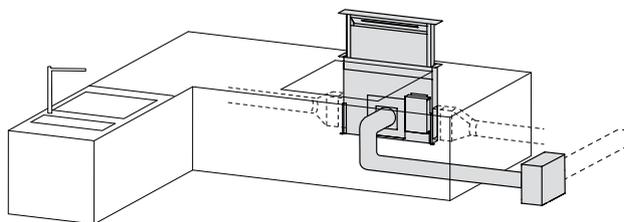
Il motore può essere installato in posizione remota interna (max 4 m di distanza dalla cappa) e non può essere installato all'esterno.
