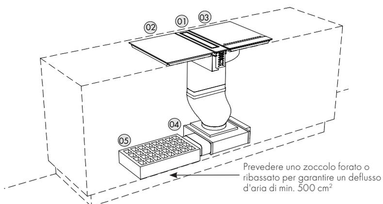
Piano cottura ed elementi canalizzazione
