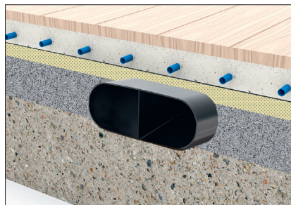
Canale piatto parzialmente di riporto e massetto con rinforzo (non secondo lo standard)
