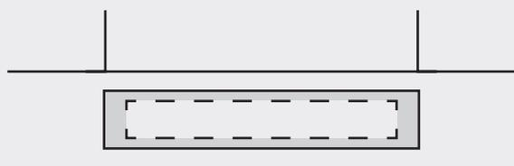
Praticare un foro nel basamento in base alle dimensioni della griglia di ventilazione. Vedere le misure espresse in millimetri (mm).
