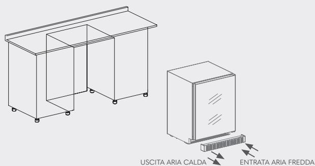
PER IL CORRETTO FUNZIONAMENTO DEL PRODOTTO DA INCASSO A QUALSIASI ALTEZZA, È IMPERATIVO LASCIARE VENTILAZIONI ALTE E BASSE. L'ARIA A TEMPERATURA AMBIENTE PENETRA ATTRAVERSO LA GRIGLIA DI VENTILAZIONE DELLA PARTE INFERIORE, SI TRASFORMA IN ARIA CALDA A CONTATTO CON IL DISPOSITIVO E FUORIESCE DALLA PARTE SUPERIORE (VEDERE LO SCHEMA DI AERAZIONE).
