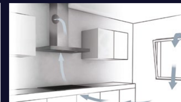
Aspirazione ad espulsione
