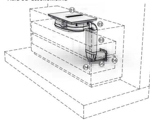
Piano cottura ed elementi canalizzazione
