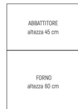
**Attenzione:** nelle installazioni a colonna bisogna inserire, dietro il forno V-ZUG, un profilo di 2/3 mm di spessore per allineare perfettamente la porta del forno alla porta dell'abbattitore.
