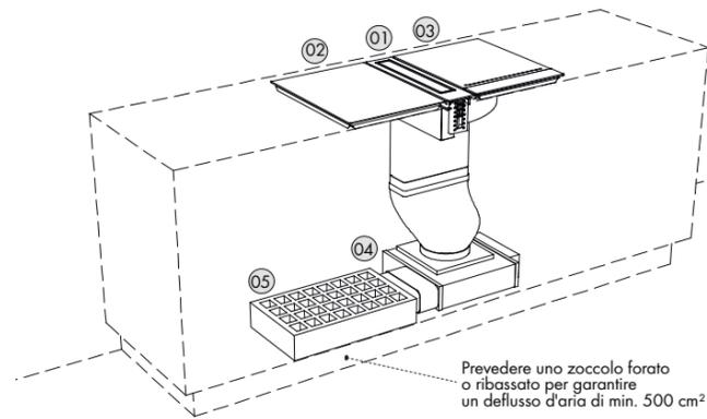
Piano cottura ed elementi canalizzazione
