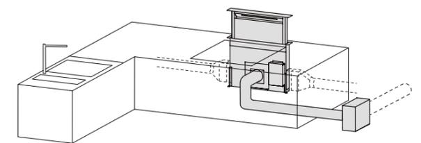
\*\*\*Il motore può essere installato in posizione remota interna (max. 4 m di distanza dalla cappa) e non può essere installato all'esterno.
