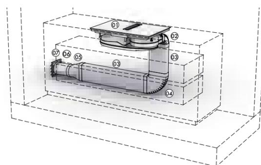
Piano cottura ed elementi canalizzazione
