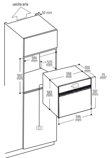
\*Spessore anta abbattitore: verificare lo spessore dell'anta del mobile adiacente per avere lo stesso allineamento.
