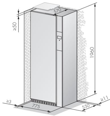
Quando il RefreshButler viene inserito all'interno di un mobile è necessario garantire il corretto flusso d'aria per il raffreddamento:
