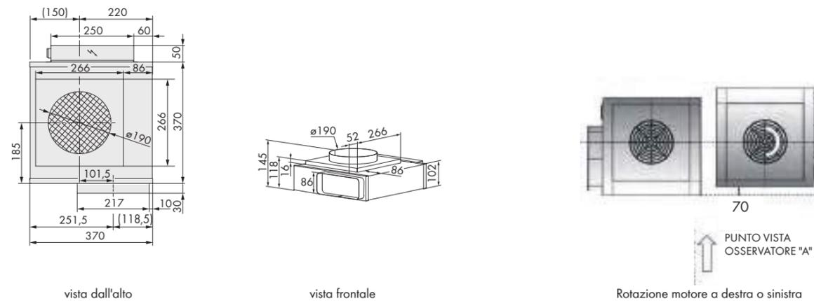
**Nota:** il centro del foro del collettore circolare del motore non coincide con il centro del corpo del motore pertanto ruotando il motore di 180° in senso orario lo stesso si sposta di 70 mm verso l'osservatore "A".
