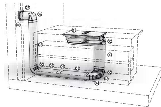
Piano cottura ed elementi canalizzazione
