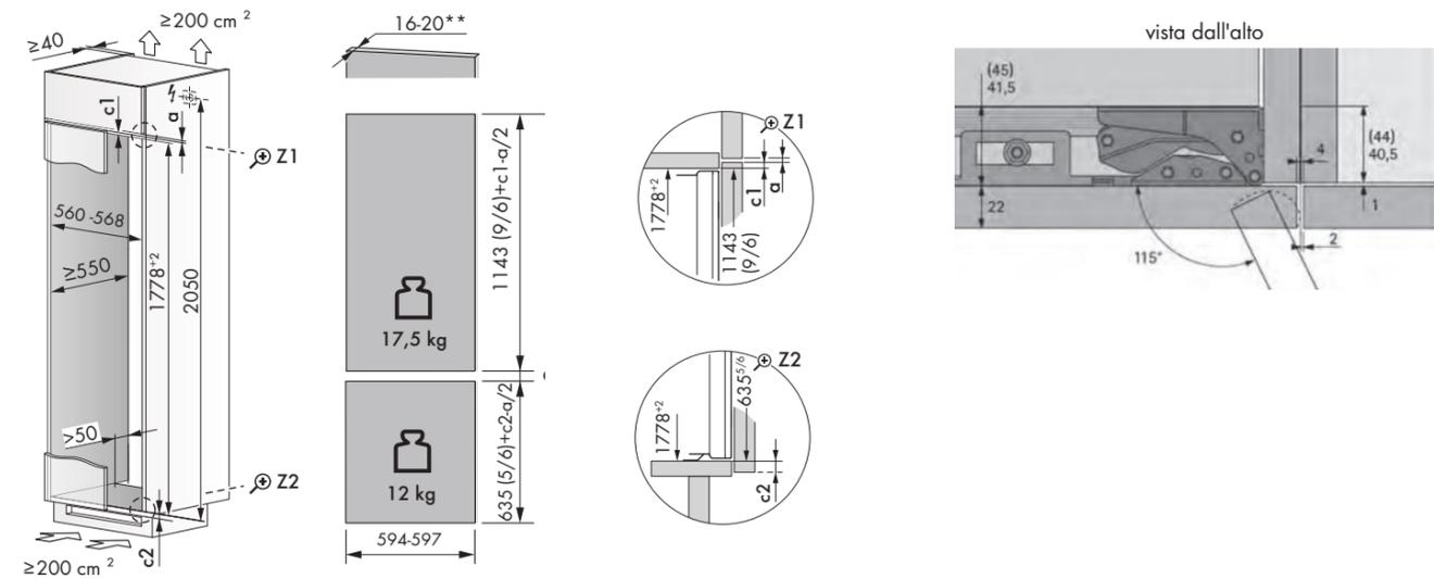
È possibile realizzare un pannello unico con peso massimo di 29,5 Kg; in tal caso si avrà accesso ai due compartimenti (frigo e freezer) simultaneamente; nel caso in cui si voglia accedere separatamente ai reparti ordinare l'apposito profilo inox (KV4000L o KV4000R).
