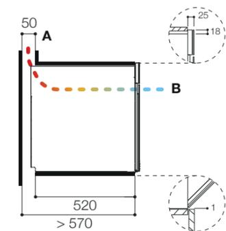
**A:** Per il ricircolo dell'aria è necessario un canale di dimensioni minime di 50 mm nella parte superiore del vano incasso.
