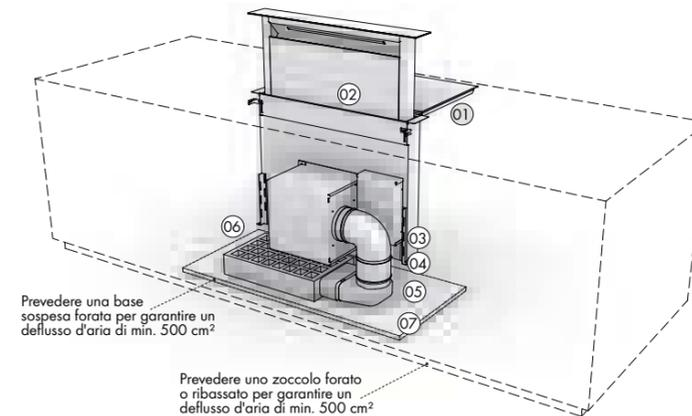
Piano cottura ed elementi canalizzazione
