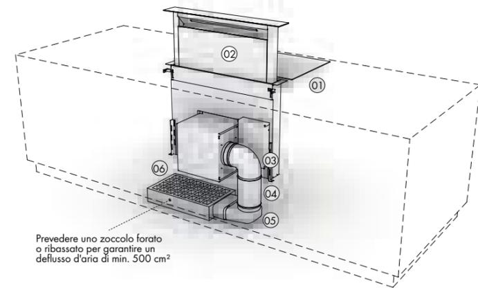
Piano cottura ed elementi canalizzazione
