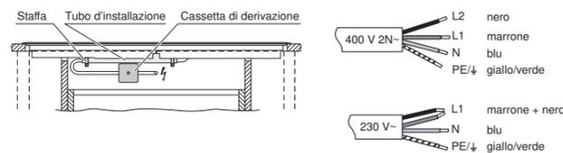
Apparecchio dotato di cavo di collegamento che deve essere allacciato a una cassetta di derivazione.
