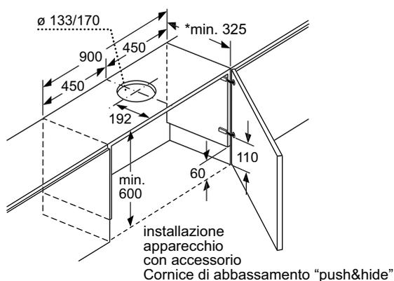
installazione apparecchio con accessorio Cornice di abbassamento "push&hide"
