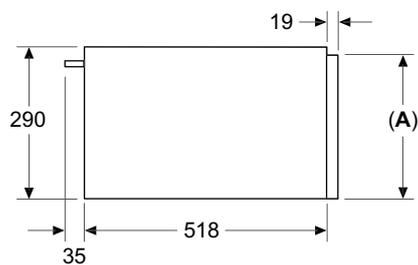
Sopra uno scaldavivande possono essere installati forni compatti con un'altezza apparecchio di 455 mm.
