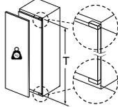
Le ante del mobile montate che superano il peso consentito possono causare danni e anomalie di funzionamento alla cerniera.
