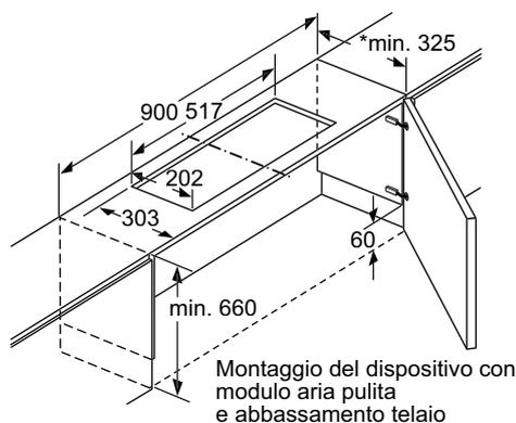
Montaggio del dispositivo con modulo aria pulita e abbassamento telaio
